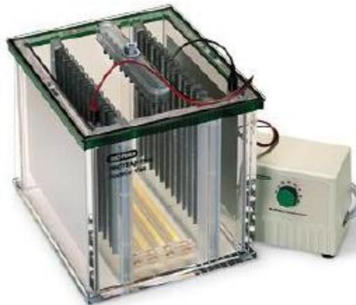
Equipo de Electroforesis Bidimensional:
