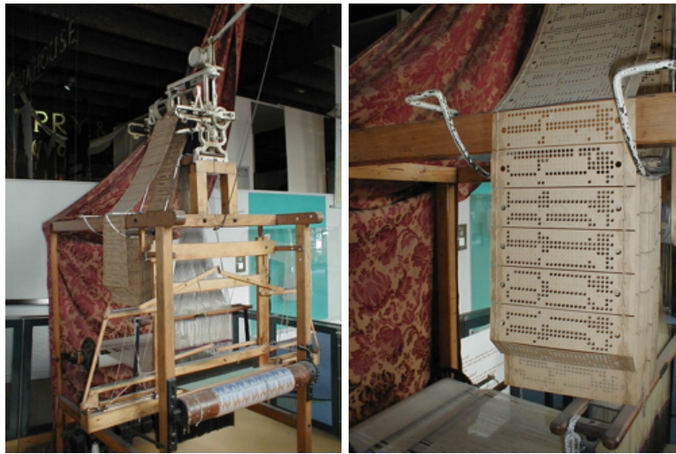
Figura 2.2: Tarjetas perforadas y telar de Jackard
